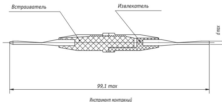
Рисунок 9 - Инструмент для вставления и извлечения контактов
