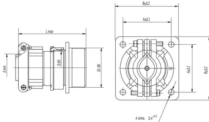
Рисунок 4 - Вилки и розетки приборные (блочные) с прямым патрубком и гайкой для неэкранированного кабеля типа 2РМ, 2РМТ
