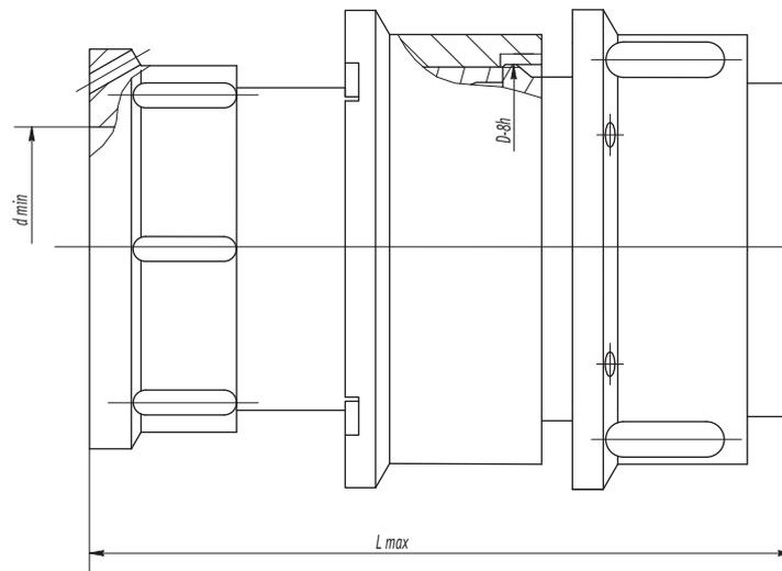
Рисунок 5- Вилки и розетки кабельные с прямым патрубком и гайкой для экранированного кабеля типа 2РМ, 2РМТ
